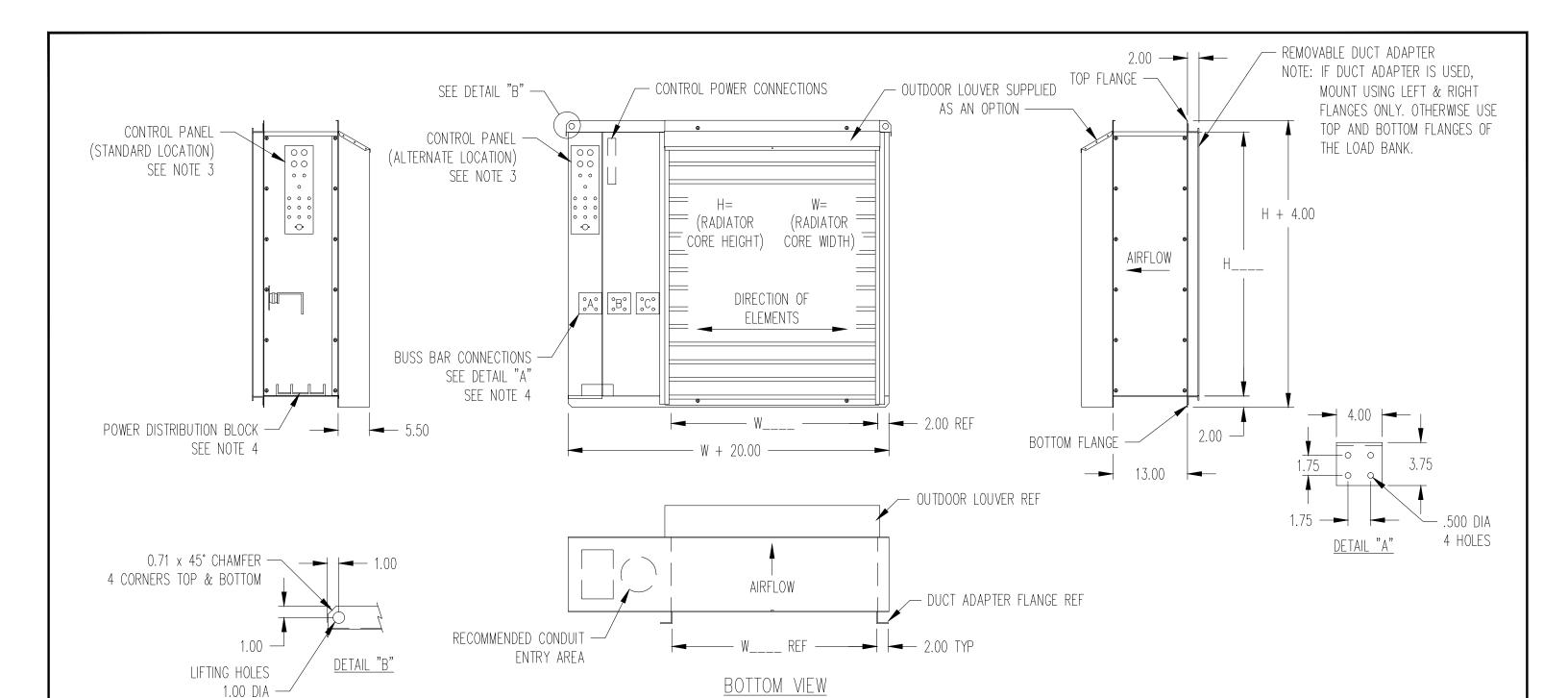
4. POWER DISTRIBUTION BLOCK OR BUSS BARS SUPPLIED DEPENDING ON LOAD BANK VOLTAGE AND KW.
